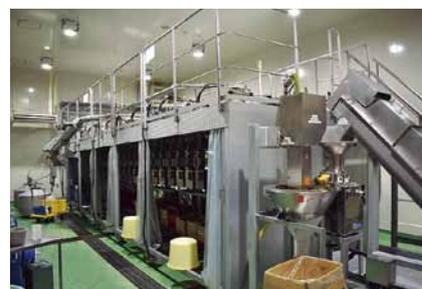
ユズ精油抽出装置「マイクロ波を利用したバイオマス再資源化装置」
