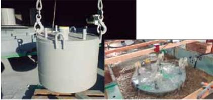
地盤液状化の際に地下埋設物が浮上する課題に対し、躯体構造により過剰間隙水圧を分散して地上に排水し、均衡を保ちつつ浮上を防ぐ耐震性貯水槽。
