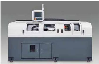
主軸毎分20,000回の高回転で、1mm以下の極小深孔加工を可能とした日本初のガンドリルマシン。部品の小型化が求められる中で極小の深孔加工ニーズに対応できる革新的な製品。
