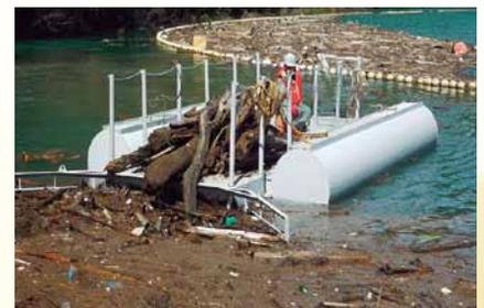
河川などに流入した大量の流木を、先端に取り付けた収集用治具で取り囲み、そのまま陸揚げ場まで運搬することができる自航艇。
