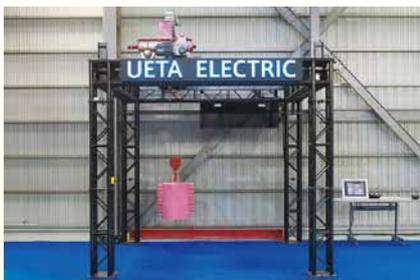
クレーン製造技術、機械制御技術にIoT技術を高次元で融合。低価格で誰でも安全に荷物の運搬ができる、クレーン荷揺れ抑制システム「ゆれ〜ん」。
