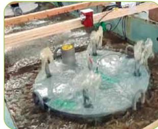
本製品は、地震などにより地盤液状化現象が発生した際に、貯水槽等の地下埋設物が浮上する課題に対して、本体構造で貯水槽の均衡を保ちつつ浮上を抑制することができる製品です。
