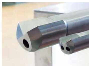
深孔加工専用の工具・ガンドリル。中心には高圧のオイルを吐出するホールが開いている。
