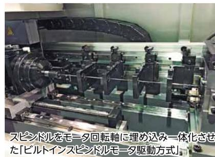
スピンドルをモータ回転軸に埋め込み一体化させた「ビルトインスピンドルモータ駆動方式」
