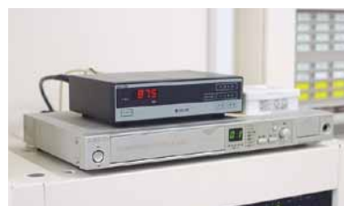
2016年9月に緊急地震速報アダプターを導入し避難訓練に活用
