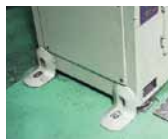
工場内の機械や棚は自社で製造した「耐震固定用L型鋳鋼品」で固定
