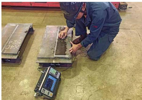
超音波探傷試験の様子。内部きずの検出や厚さの測定に使用される。非破壊検査は検査用途に応じ、様々な検査手法が用いられる
