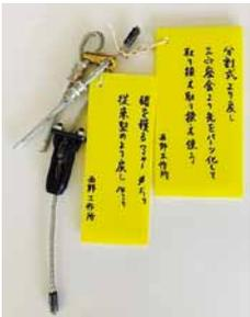
猪、鹿、猿を獲るワイヤー…締めつけ部と根付け部をつなぐより戻し(分割できるより戻し)「分割式より戻し」はボルトでワイヤーをつなぐパーツとなっており、ワイヤー切等が必要なく、わなの取り換えをすることができます。
