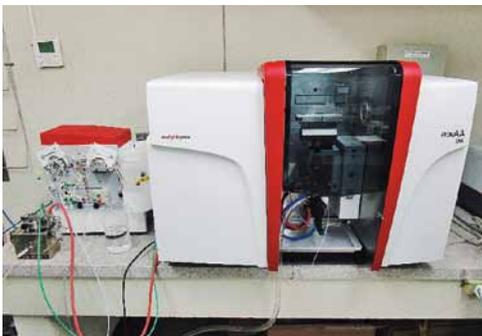
原子吸光分光光度計 「フレイム法・水素化物発生法」
