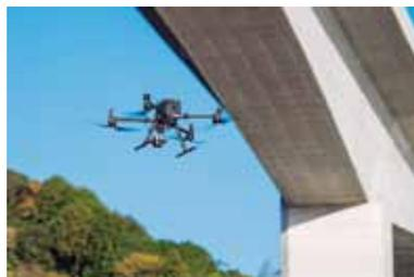
赤外線画像解析カメラ搭載ドローン
