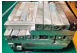
↑ 発泡スチロールゴミの資源化:社内溶解・インゴット化し、プラスチック原材料として出荷
