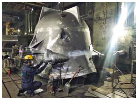
鋳鋼品の仕上げ工程
