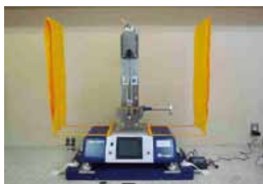
衝撃試験機 (株)東洋精機製作所(型式:IT型)
