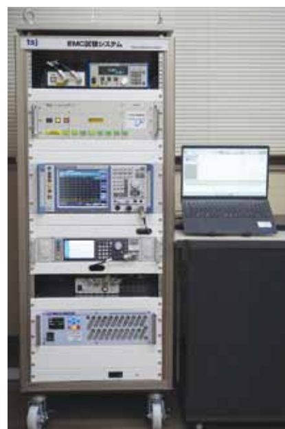
伝導EMC試験システム (株式会社テクノサイエンスジャパン)
