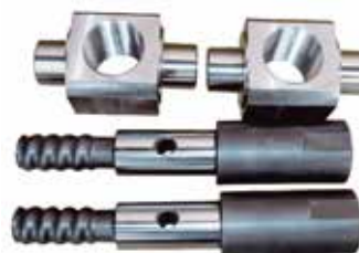
S45C ® φ220×1030 (120台形2条ネジP10・リード20) LBC4 φ165×210 (120台形2条ネジP10・リード20)
