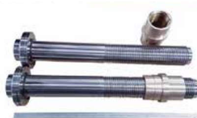
S45C ® φ220×1030 (120台形2条ネジP10・リード20) LBC4 φ165×210 (120台形2条ネジP10・リード20)
