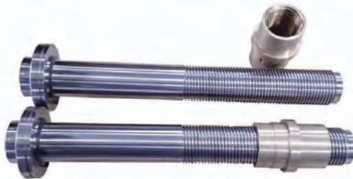
S45C (H) φ220x1030 (120台形2条ネジ"PI0リード"20) LBC4 φ165x210 (120台形2条ネジ"PI0リード"20)
