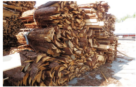
全面が剥げていない状態
