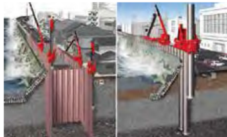
鋼矢板二重締切 (左)、鋼管杭連続壁 (右)
