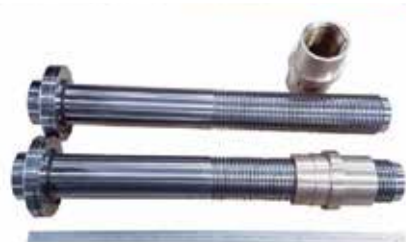
S45C ④ Φ220×1030 (120台形2条ネジP10・リード20) LBC4 Φ165×210 (120台形2条ネジP10・リード20)
