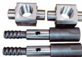
S45C ④ Φ220×1030 (120台形2条ネジP10・リード20) LBC4 Φ165×210 (120台形2条ネジP10・リード20)
